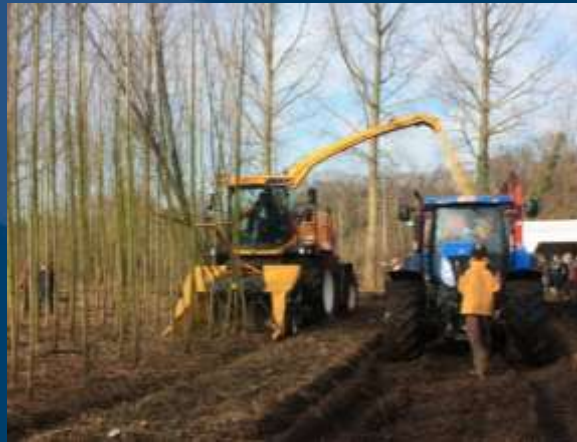
Coppice Header 130 FB van Case New Holland gemonteerd op een maïshakselaar (foto Probos )
