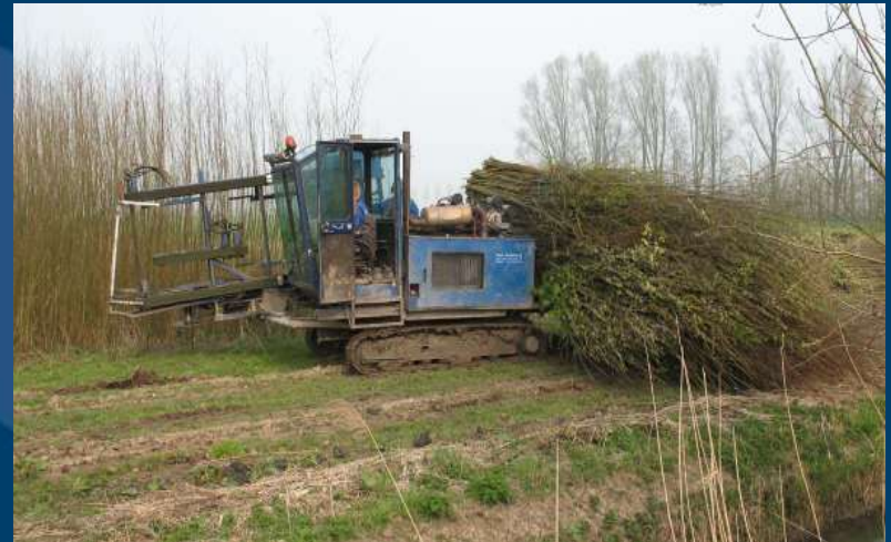
Oogstmachine uit de griendcultuur (foto Van Aalsburg Griendhouhandel B.V.)
